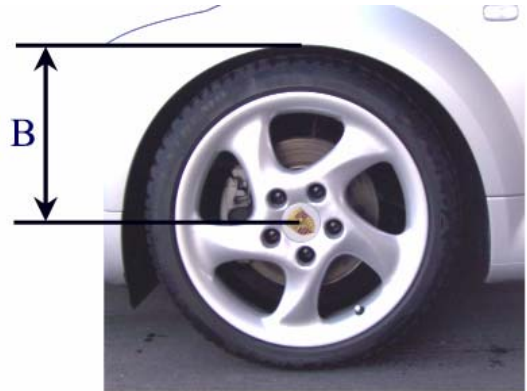
Abstandsmaß B - Radmitte - Kotflügelunterkante
