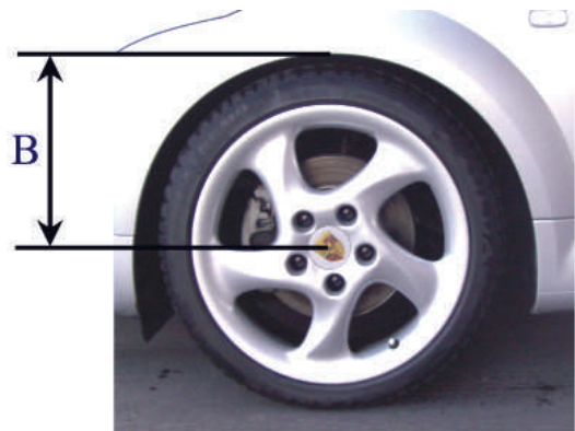
Abstandsmaß B - Radmitte - Kotflügelunterkante
