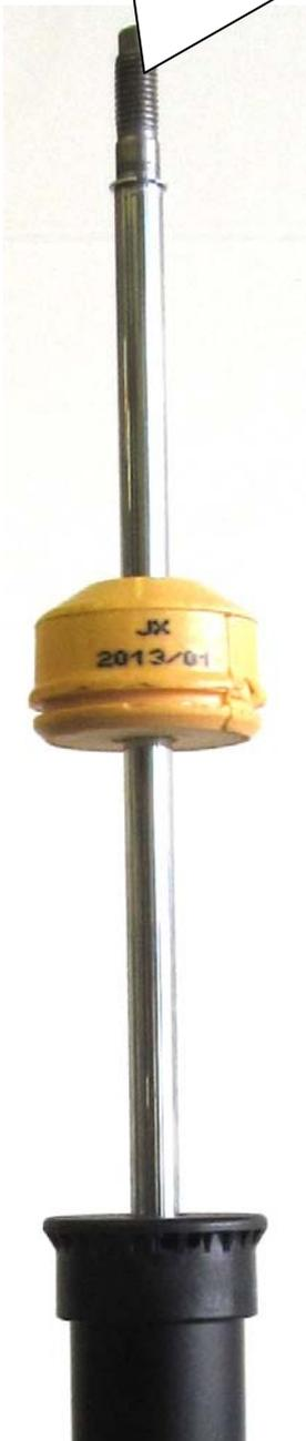
Anschlagelament mit Staubschutzrohr auf den Dämpfer aufstecken.
