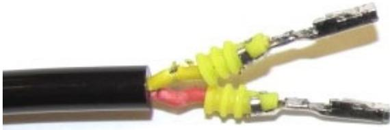
4. Steckersicherung öffnen. Fertig montierte Leitung mit Abdichtungen in das Gehäuse ganz einschieben und einrasten. Pinposition / Kabelfarbe ist nicht relevant. Anschließend Steckergehäuse verriegeln.
