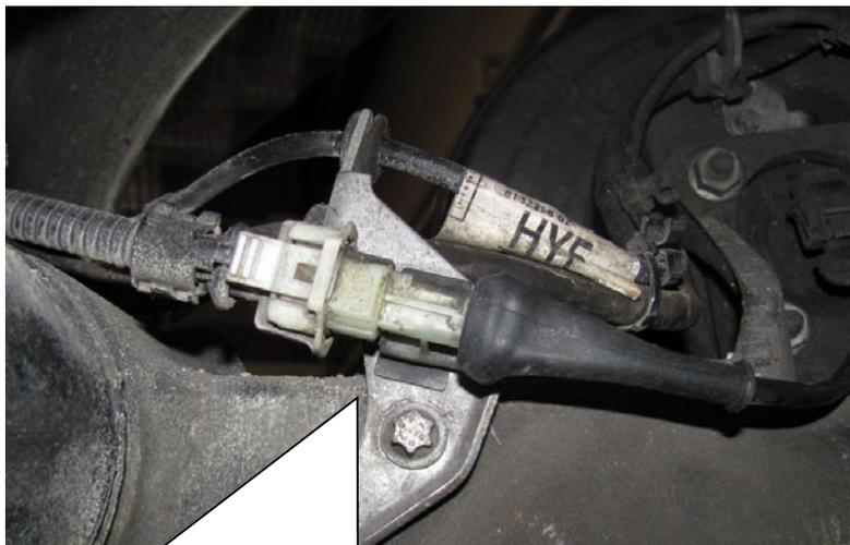
Stecker des Elektronikbauteils in den Original Stecker einstecken. Auf die korrekte Verriegelung der Buchse achten! Anschließend originale Dämpfersteuerungsleitung mit Kabelbinder befestigen.
