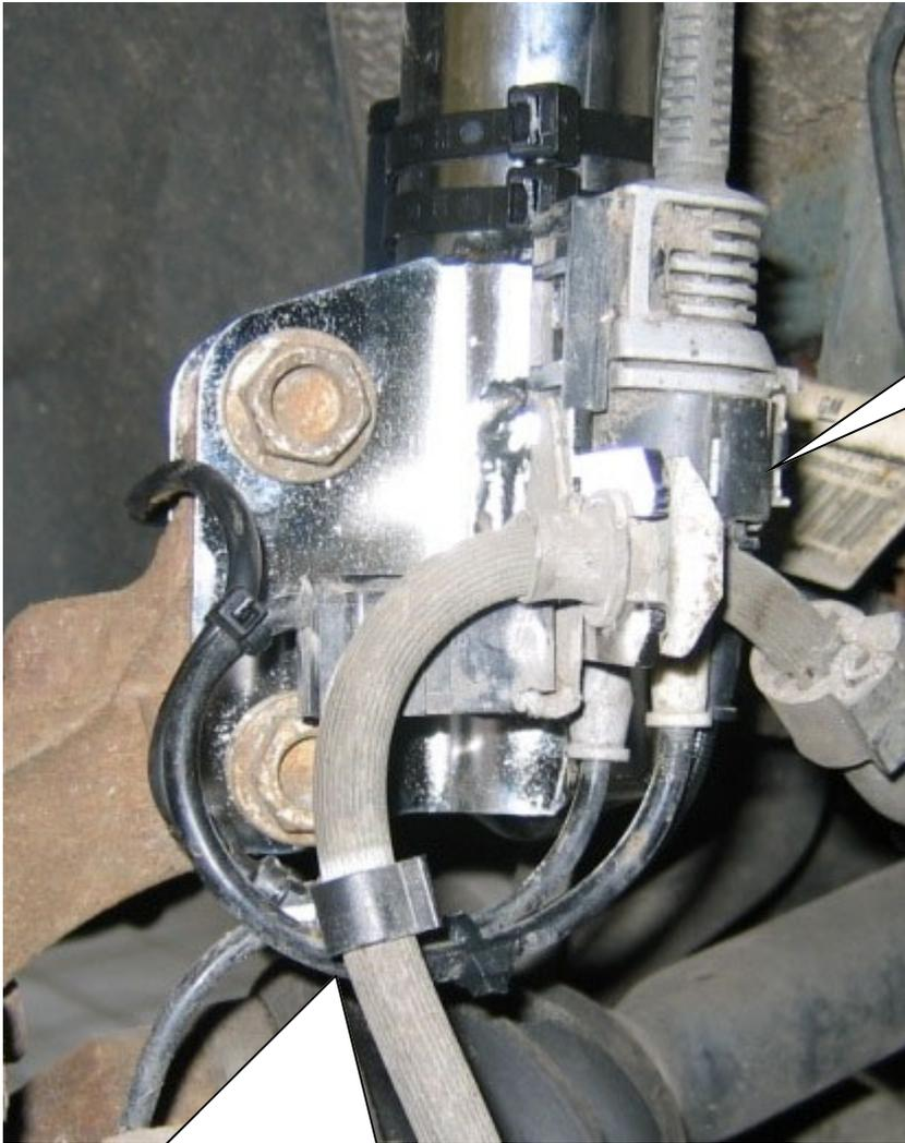
Stecker des Elektronikbauteils in die Original Buchse einstecken. Auf die korrekte Verriegelung des Steckers achten! Anschließend die neue Leitung mit Kabelbinder befestigen.
