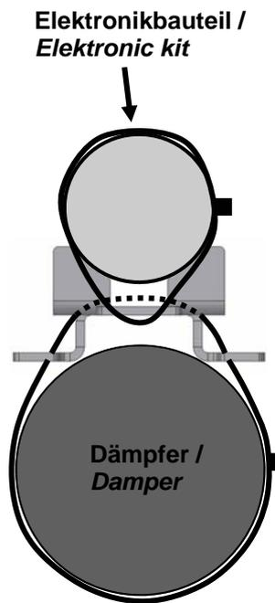
Mitgelieferter Elektroniksatz mit Kabelbindern 4,8mm x 290mm befestigen. Originale Dämpfersteuerungsleitung in den mitgelieferten Elektroniksatz einstecken. Auf die korrekte Verriegelung des Steckers achten! Anschließend originale Dämpfersteuerungsleitung mit Kabelbindern befestigen.
