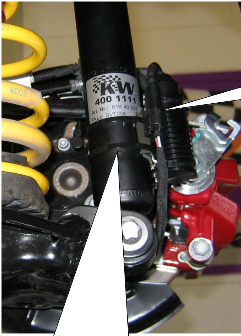
Originale Dämpfersteuerungsleitung evtl. mit Kabelbindern befestigen.
