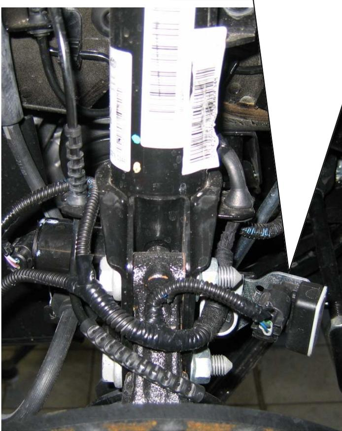
Mittelgelieferte Halterung an das KW Federbein montieren. Steuergerät mit Schrauben oder Nieten an der Halterung befestigen
