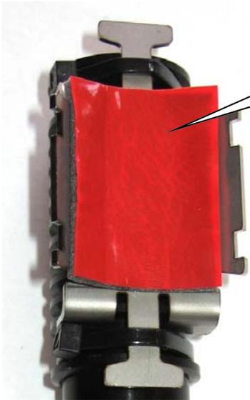
Stilllegung am Dämpfer mit dem Klebeband und Kabelbinder 4,8mm x 290mm befestigen.
