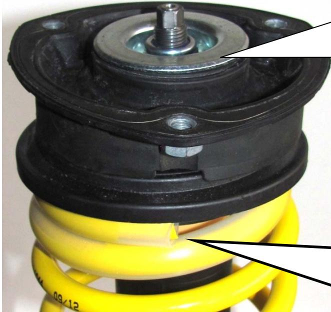
Das originale Stützlager aufsetzen und mit der im Lieferumfang enthaltenen Mutter festschrauben. Das Anzugsdrehmoment der Kolbenstangenbefestigung beträgt 50 Nm. Die Montagehinweise zum Einbau des Federbeines in das Fahrzeug, sowie die Anzugsdrehmomente der Federbeinbefestigung, entnehmen Sie bitte den Unterlagen des Fahrzeugherstellers.
