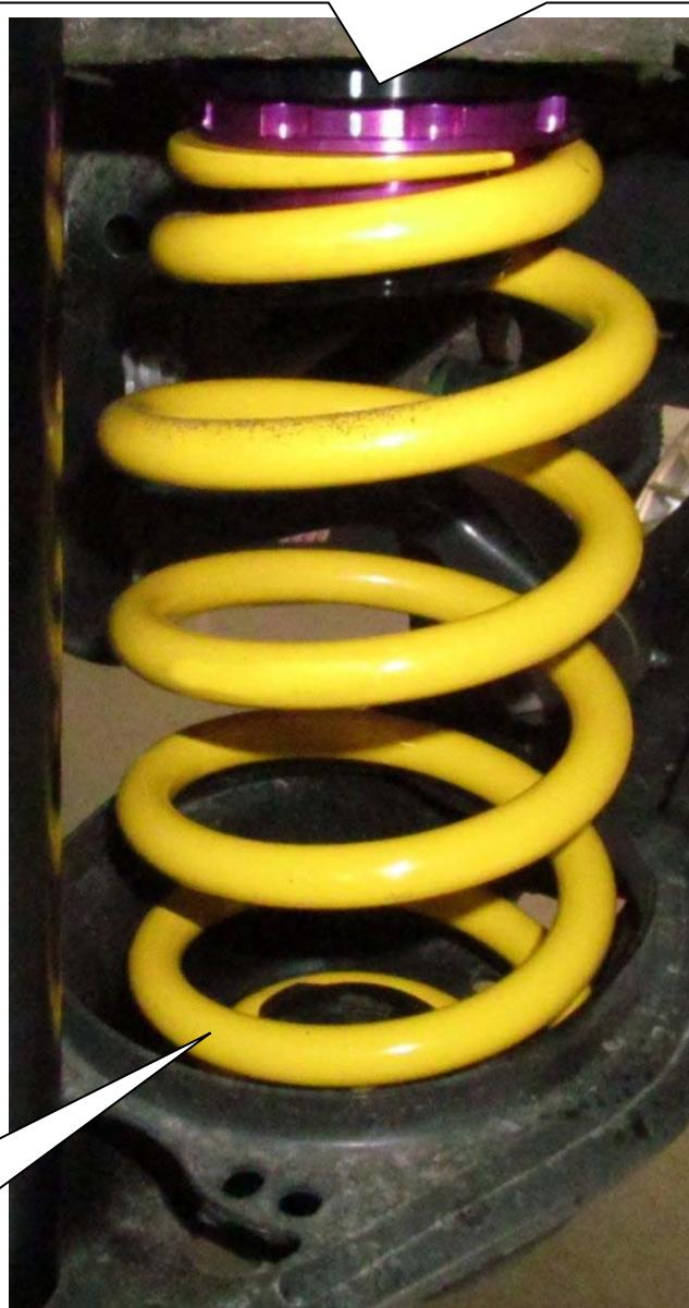
Am unteren Ende der Feder wird die originale Federunterlage weiterverwendet.
