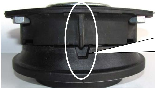
Beide Markierungen des originalen Stützlagers (Oberteil) und originalen Axiallagers (Unterteil) müssen übereinander liegen! Die Markierungen zeigen im Eingebauten Zustand zur Fahrzeuginnenseite.
