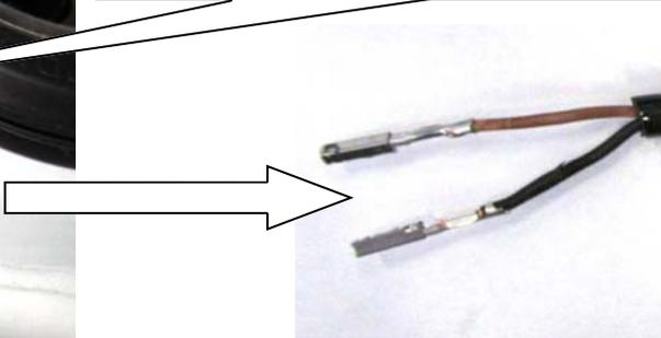
3. Originale Leitungen in den mitgelieferten Stecker ganz einschieben und einrasten. Pinposition / Kabelfarbe ist nicht relevant. Anschließend den Stecker verriegeln.
