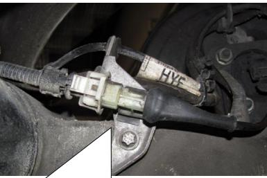
Stecker des Elektronikbauteils in den Original Stecker einstecken. Auf die korrekte Verriegelung der Buchse achten! Anschließend originale Dämpfersteuerungsleitung mit Kabelbinder befestigen.
