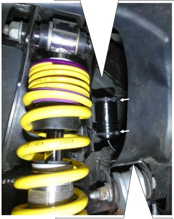
Leitung und Steckverbindung mit Kabelbindern befestigen.
