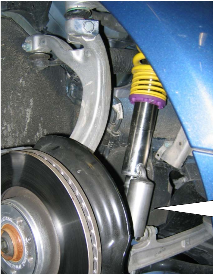
Bei Dämpferversionen mit Druckausgleichsbehälter ist dieser, wie auf dem Bild zu sehen, zur Fahrzeugvorderseite zu montieren. On damper versions with compression balancing case, mount the case in the position to the front side as shown on the picture.
